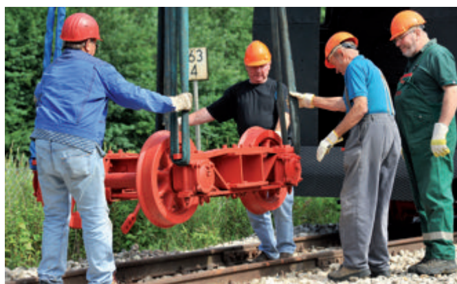
Das Fahrgestell des Tenders (insgesamt hat der Durlesbach-Tender vier Achsen) wird aufs Gleis gesetzt (rechts Berthold Halder). Anschließend wird der Tender aufgesetzt (Bild rechts). Der Tender wiegt im Leerzustand 10,6 Tonnen; der Kohlebehälter hat ein Fassungsvermögen von 4 Tonnen, der Wasserbehälter kann 6000 Liter mitführen.
